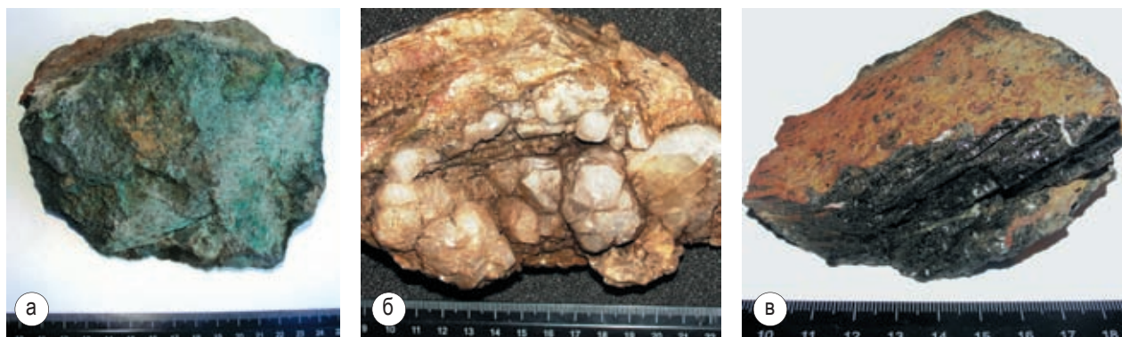
Рис. 8. Минералы из отвалов рудника «Надежда»: а – халькозин (левая часть образца) и медная зелень (правая часть), б – кальцитовая жила и друза кальцита, в – черный слюдоподобный стильпномелан
