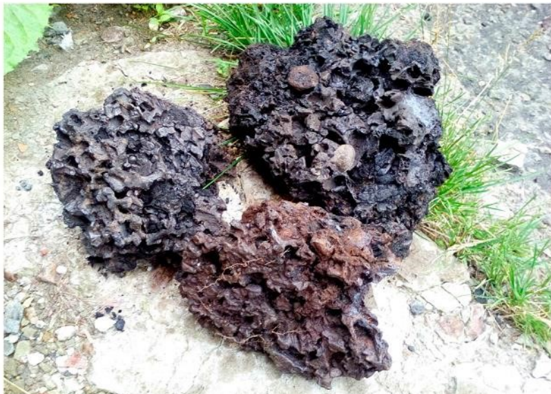
Отходы железоделательного производства в д.Совдозеро: древесный уголь и куски шлака. (Фото1 (журнал «Karjalan heimo»), фото 2,3,4.(Щипцов К.В.)
