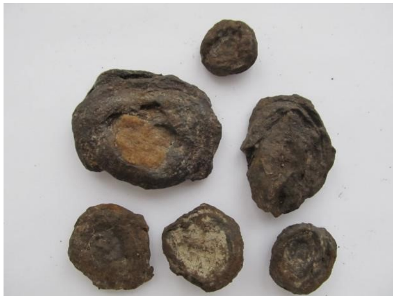
Монетная озерная железная руда. Размеры; от 4x5x0.5 см до 0.8x0.8x0.1 см. оз. Сундозеро, Кондопожский р-н. Колл: Сацука Ю.И. Образец находится в коллекции музея геологии докембрия, ИГ. КарНЦ
